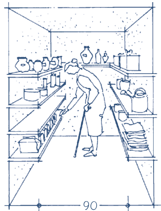
Abstellraum, der von Menschen mit Bewegungseinschränkung mit Gehhilfen genutzt werden kann; ein Rollator kann ggf. nur rückwärts ausgefahren werden
