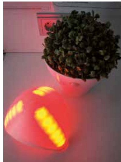
Der „Blumentopf“ registriert Bewegungs- abläufe und wertet diese auf Standard- abweichungen aus; je stärker die Abweichung desto roter (von grün kommend) wird die Signal-einheit, die bei den – ggf. weit entfernt lebenden – Angehörigen steht.
